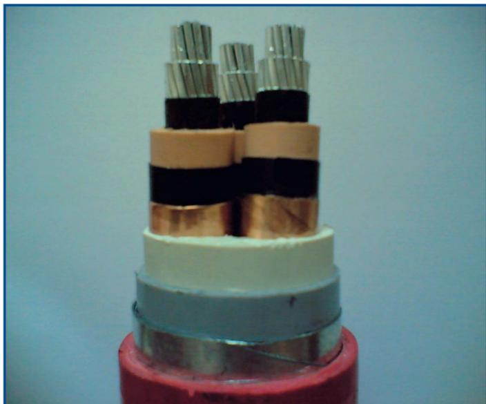
Изоляция ЭПР обеспечивает бесперебойную работу кабеля при рабочей температуре проводника равной 90°C, с пиковыми значениями до 130°C, и удовлетворяет высоким значениям допустимой токовой нагрузки, оставляя при этом хороший запас прочности.
