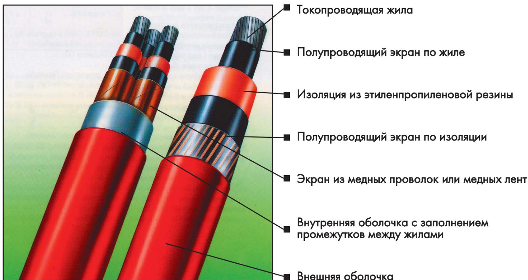
Проводник представляет собой круглую, многопроволочную, уплотненную жилу из медных или алюминиевых проволок класса 2, согласно стандарта CEI 20-29.
